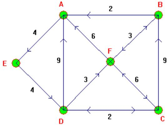
On souhaite trouver la chaîne de poids minimal de C à A.
